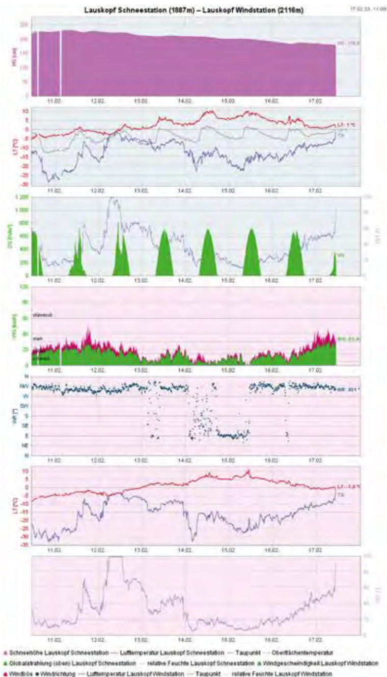
17 Milde Temperaturen, starke Sonneneinstrahlung und trockene Luft führten Mitte Februar zu einem deutlichen Rückgang der Schneehöhe. (Quelle: LWD Salzburg) |
