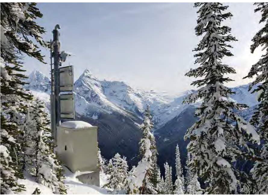
05 LARA@-Lawinenradar am Rogers Pass in British Columbia. Links der Mast inkl. Sensor, Stromversorgung und Datenübertragung und rechts die Radarantenne mit Blick auf den Detektionsbereich am Gegenhang. (Fotos: Wyssen)
