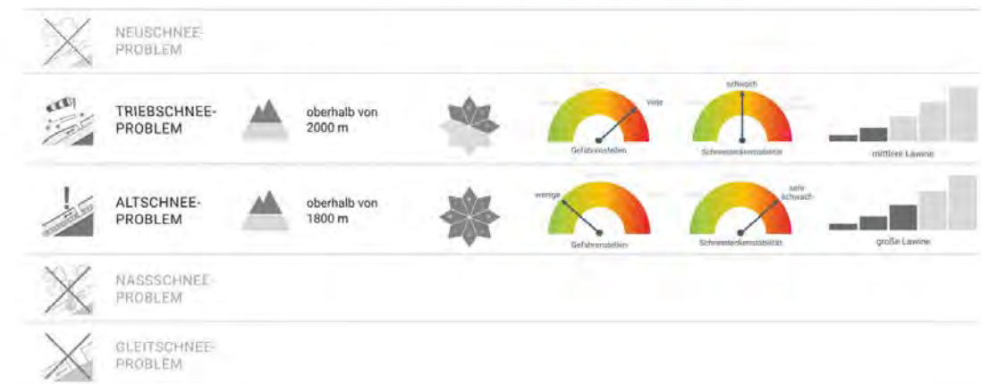
04 Beispielhafte Darstellung einer lokalen Lawinenlage mit dem LO.LA Safety Tool. Die ermittelte Gefahrenstufe ergibt sich immer aus dem relevantesten (am höchsten bewerteten) Lawinenproblem. Für alle ausgewählten Probleme wird neben dem Höhenband und der Exposition auch die Frequenz der Gefahrenstellen, die Schneedeckenstabilität sowie die zu erwartende Lawinengröße angegeben (Grafik: LO.LA).
