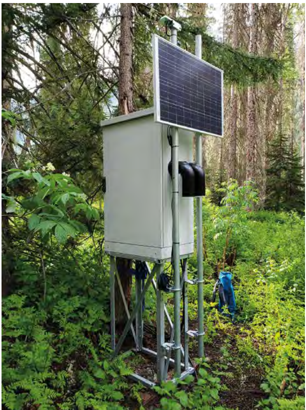
04 IDA@-Infraschall-Detektionssystem am Rogers Pass in British Columbia. Links die Basisstation inkl. Stromversorgung und Datenübertragung und rechts einer der sternförmig von der Basisstation verlegten Infraschallsensoren. (Fotos: Wyssen)
