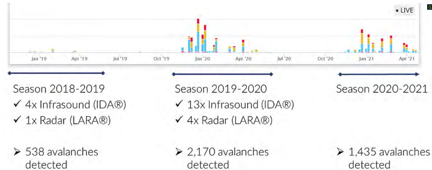
07 Übersicht über die installierten Anlagen in den ersten drei Projekt-Winter sowie die in den drei Saisonen detektierten Lawinenereignisse im Bereich Rogers Pass in British Columbia. (Grafik: Wyssen)
