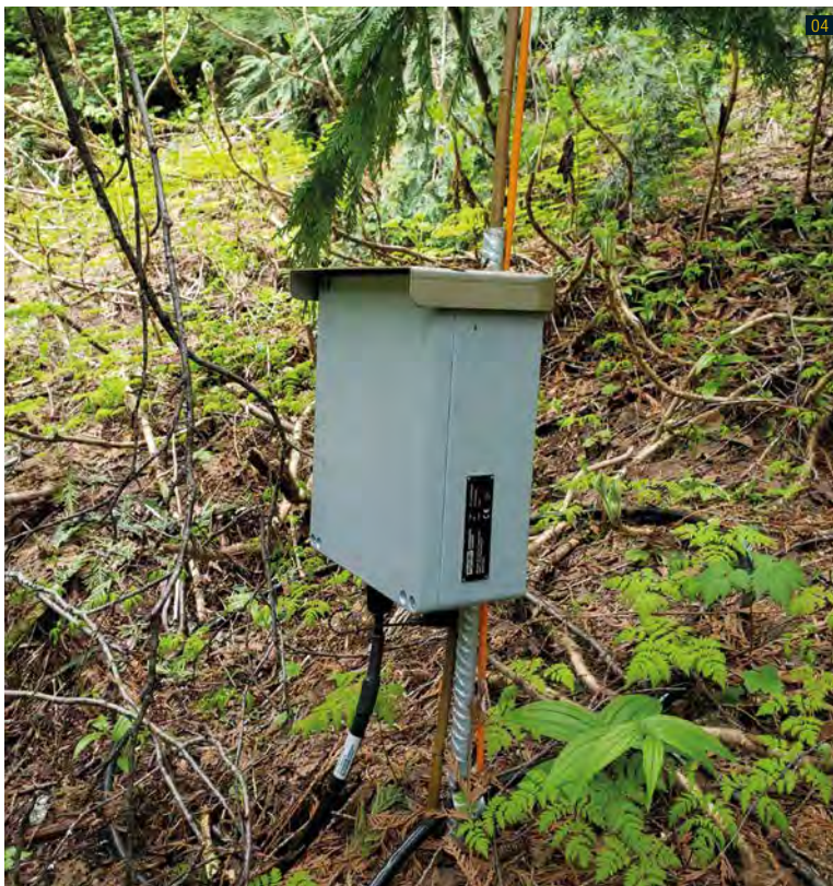
04 IDA@-Infraschall-Detektionssystem am Rogers Pass in British Columbia. Links die Basisstation inkl. Stromversorgung und Datenübertragung und rechts einer der sternförmig von der Basisstation verlegten Infraschallsensoren. (Fotos: Wyssen)
