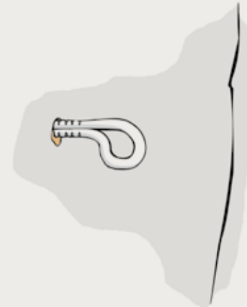
Abb. 26 Bohrloch zu wenig tief
