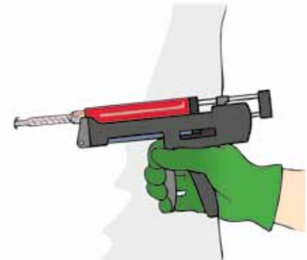
Abb. 20 Befüllen des Bohrlochs
