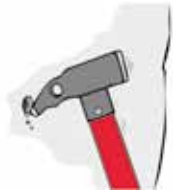
Abb. 17 Abrunden des Bohrlochs
